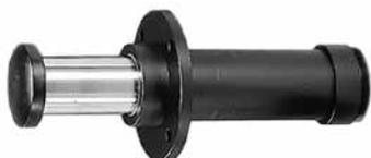
Les **amortisseurs de sécurité** sont utilisés pour apporter de la sécurité dans les applications d'arrêt d'urgence. Magasins automobiles, convoyeurs ou ponts roulants, ils sont une alternative économique aux amortisseurs industriels. Les amortisseurs de sécurité sont sans entretien, autonomes et construits avec une butée positive intégrée. Ils se caractérisent par un accumulateur à diaphragme intégré ou
