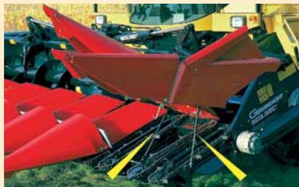
Protection élevée: les ressorts à gaz industriels maintiennent et assistent l'ouverture et la fermeture des capots lourds
