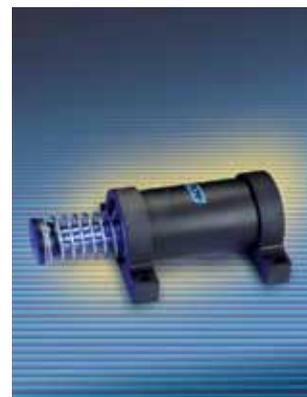
Les séries ACE A1½ à A3 couvrent des masses effectives de 0,3 kg à 204 000 kg. La série A, robuste, est conçue pour des applications réellement difficiles. Les appareils sont réglables par une vis à six pans creux à l'arrière du corps. La série A réglable peut remplacer les anciens modèles SAHS avec les mêmes dimensions et fixations (nous contacter pour plus d'information). Les amortisseurs A sont sans entretien et prêts à l'emploi.
