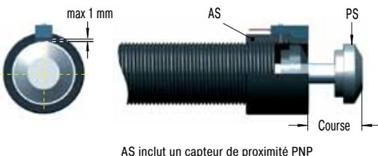
Le système de détection ACE peut être installé sur tous les amortisseurs courants. **Avantages:** encombrement très court et compact, bon rapport prix/performance, peut être installé sur un amortisseur standard, réglage fin du signal par rapport à la course.
