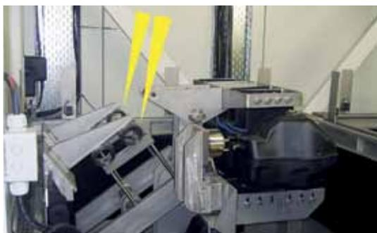
Les absorbeurs profilés TUBUS d'ACE sont des réelles alternatives pour les applications dans lesquelles les charges ne doivent pas être positionnées exactement ou ne nécessitent pas une absorption de 100 %.
