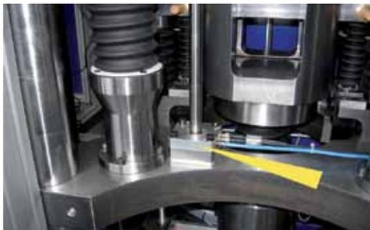
Les systèmes de blocages de la gamme ACE-LOCKED offrent des forces de serrage importantes et cela avec un temps de réaction très court grâce au système pneumatique avec ressorts précontraints. Les mâchoires de serrage sont spécialement prévues pour un serrage et blocage direct sur rails linéaires, tiges ou arbres cylindriques. Les mouvements axiaux ou radiaux peuvent être bloqués ou freinés avec ces produits.
