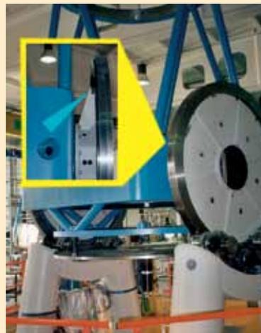
Protection parfaite des dépassements de courses sur un télescope de précision
