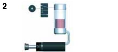
Pas de force de rappel en position rentrée, réarmement de l'amortisseur par commande pneumatique.
