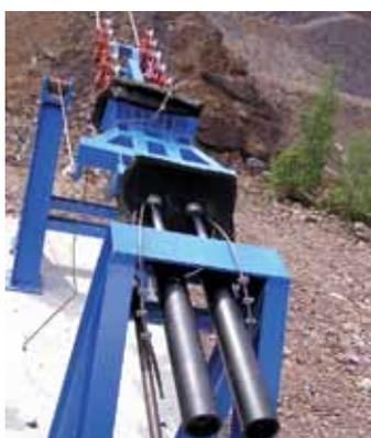
Les amortisseurs de sécurité ACE sont conçus pour des situations d'arrêt d'urgence dans l'industrie ou avec des systèmes transstockeurs. Ils offrent une alternative économique aux amortisseurs de chocs industriels pour ce type d'application.
